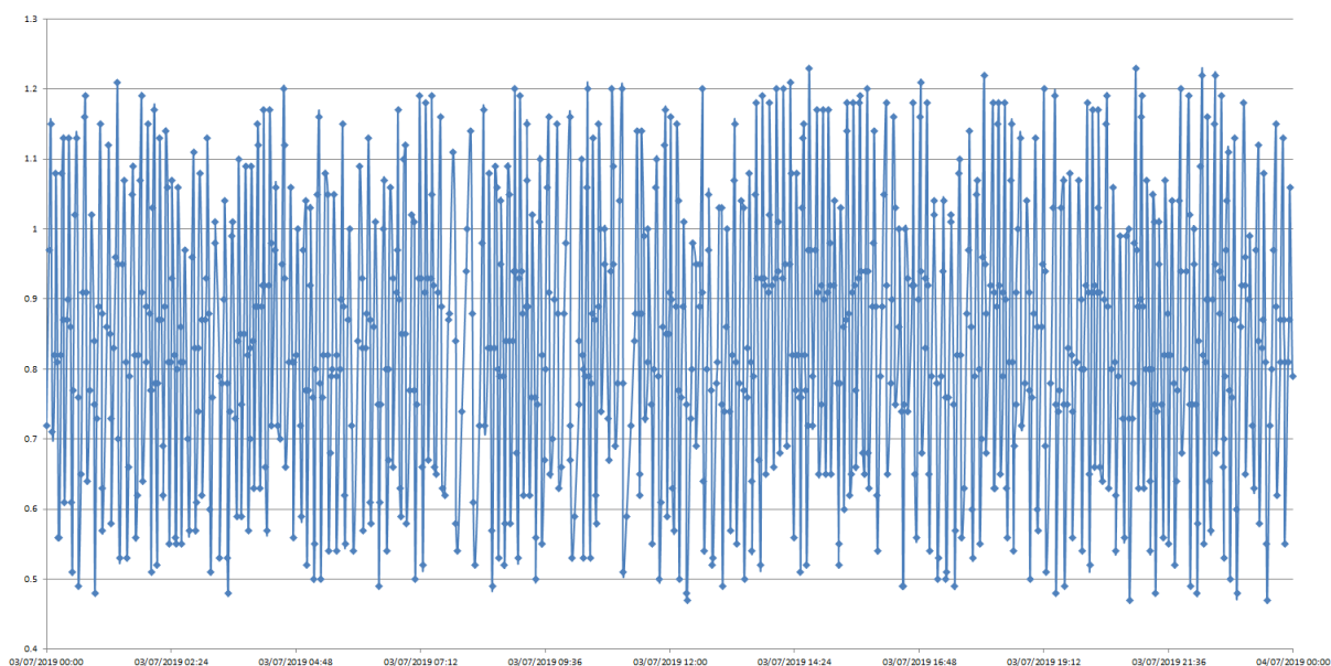
Figure 12 : niveau dans le poste de refoulement pour la journée du 03/07
