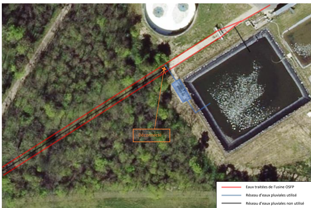
Figure 9 : situation après les aménagements prévus en septembre 2020
